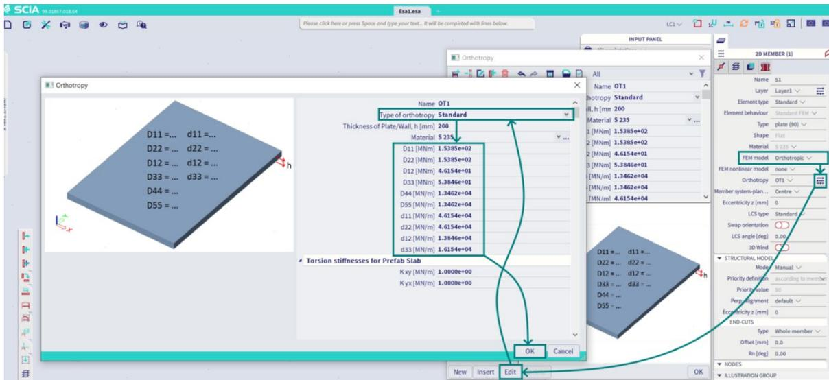
Lors du calcul, les raideurs des panneaux CLT sont correctement prises en compte dans l'analyse. L'étape suivante consiste à évaluer les efforts internes qui en résultent au moyen de contrôles automatiques. Nous recommandons vivement la publication de proHolz (2014) : Cross-Laminated Timber Structural Design) dans lequel vous trouverez des méthodes pour vérifier un panneau CLT.
