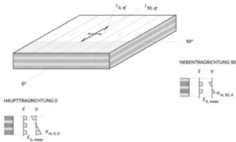
Pour les contraintes de flexion, seules les couches orientées dans la direction respective sont prises en compte. Les couches orientées dans l'autre sens jouent le rôle d'écarteurs et ne sont chargées en cisaillement que dans la direction principale de la charge.
