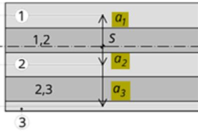
$I_{90,net}$  : moment d'inertie net dans la direction porteuse secondaire (90°), c'est-à-dire que seules les couches dans la direction porteuse secondaire doivent être prises en compte à l'aide de la formule ci-dessous :
