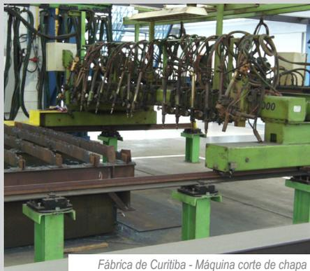
Fábrica de Curitiba - Máquina corte de chapa
