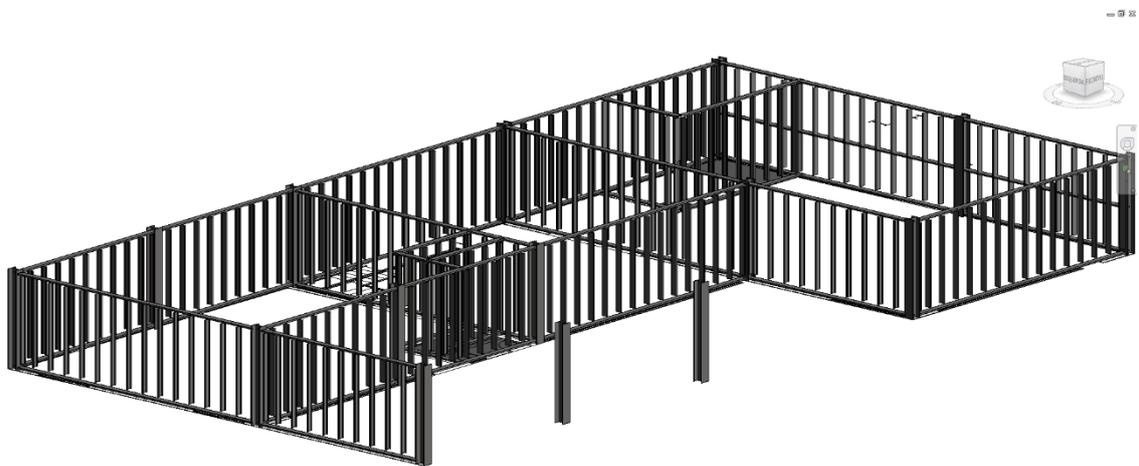
Figura 36 – Pré Lançamento Steel Framing no Revit 2015
