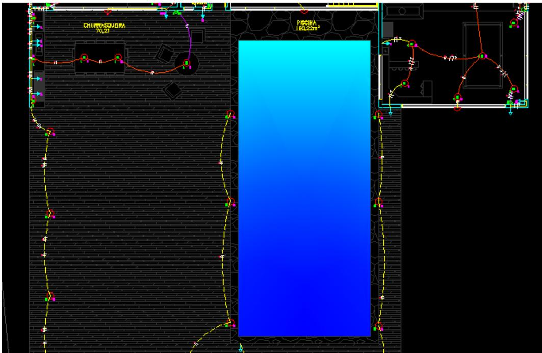
Figura 81– projeto elétrico planta baixa deck piscina
